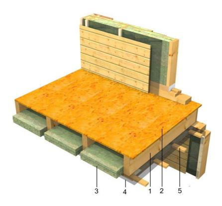
1- Structure bois: elements prefabrique en BLC, CL-2,a 15% d' humiditee, rabotee poutres 80/240mm a un ecartament de 41cm
